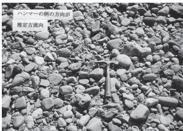
写真3 砂礫堆上の礫のオリエンテーション（推定古流向はハンマーの柄の方向）
