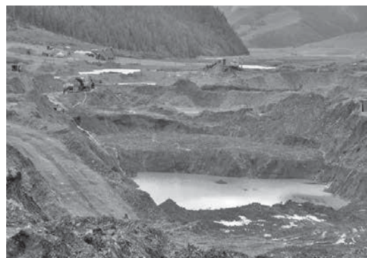
写真1 オルホン川 沈殿池
