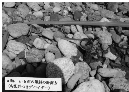
写真3 勾配計付きデバイダーによる傾斜角の計測
